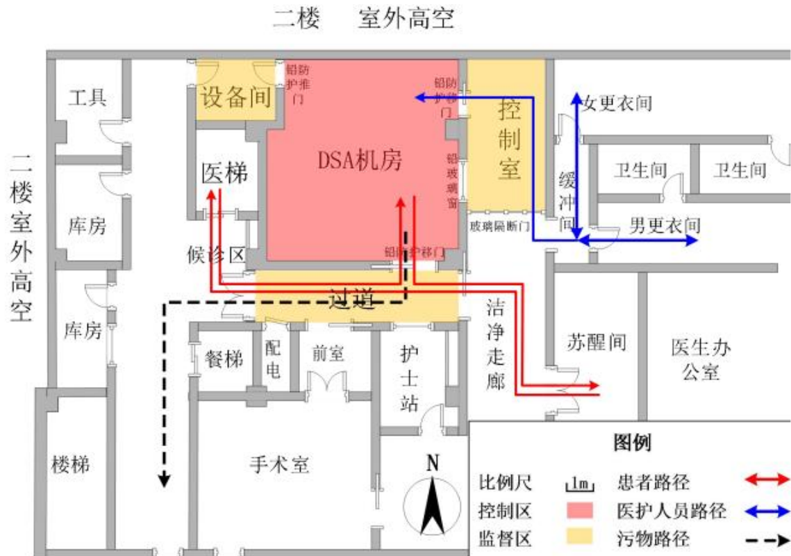
图 3-1 DSA 工作场所分区平面示意图
